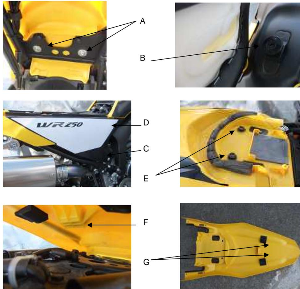
フェンダー裏の2本のボルト(A)をはずして、シート前部のスライドフック(B)から抜く為にシートを後方へ引くようにしてはしません。
