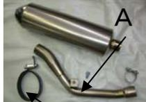
ジョイントパイプに純正ガスケット(品番5PX-14755-00)を装着して付属バンドを(細)を通してエキパイ(A)と仮接続します。
