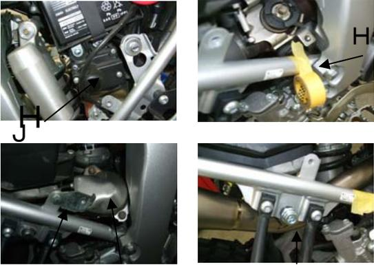
サイレンサー取付けボルト2本(F)を緩め(取り外さない事)、エキパイジョイントバンド(G)を緩める。
