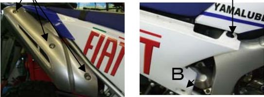
サイドカバー前方を引っ張り(乗車して外側へ)、ゴムクランプ(C)から取り外し、サイドカバーを前方向にスライドさせ取り外す。
